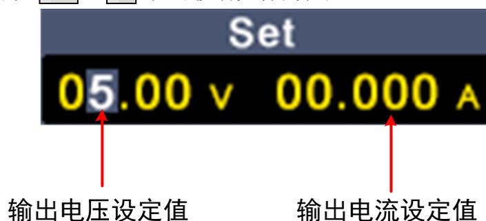
注：当输出电流 > 10A 时，请勿使用香蕉头连接电源输出端！
