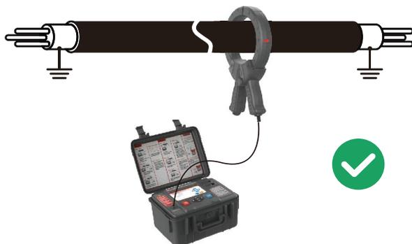
图 5- 15 运行电缆耦合法 1（卡电缆本体）
