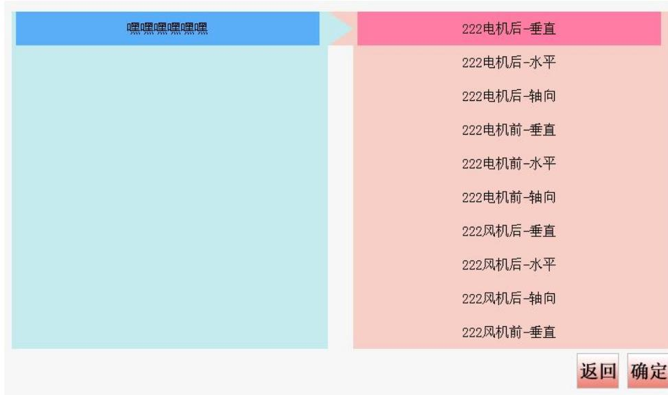
2.3.3 测量所有测点之后, 使用 USB 线连接电脑, 打开软件, 等待电脑【移动设备中心】里显示已连接, 然后仪器在数据管理页面按【↑】开始上传数据。提示上传完成后, 可在电脑软件中查看数据。
