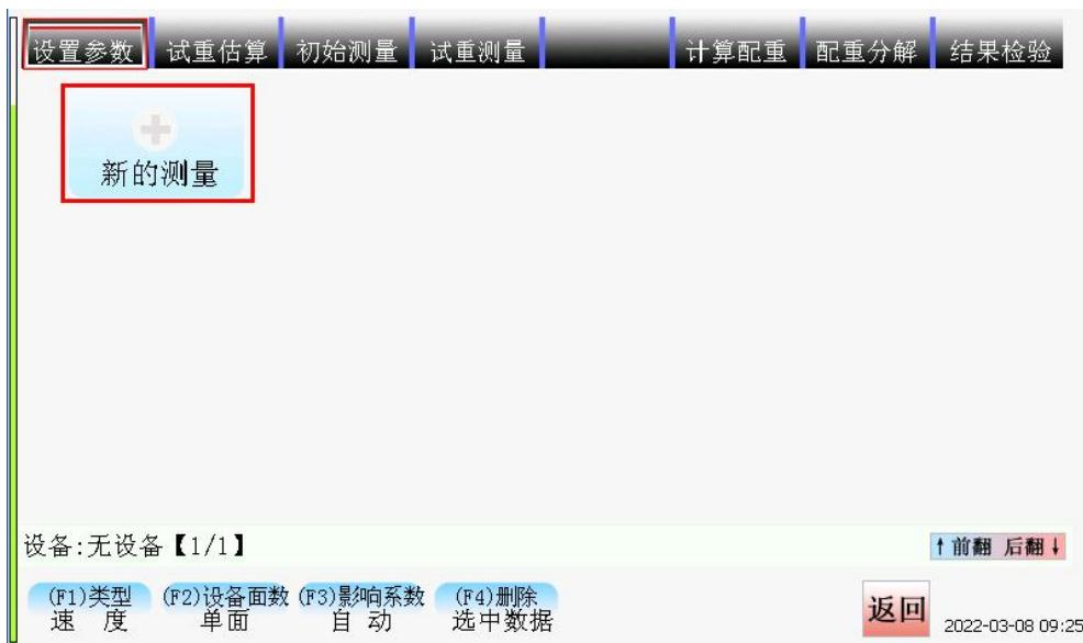
动平衡设置参数界面会列出该设备最近的动平衡测量日期，选择【新的测量】开始一次全新的动平衡测试。用键盘【F1-F3】进行参数的切换不会展开菜单，按键会直接切换。
