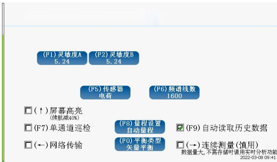
首次使用仪器必须先进【(F9)参数设置】菜单中，设置自己的所购买的传感器灵敏度和传感器类型，F1-F4进入某个通道的灵敏度编辑状态。
