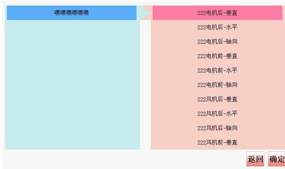
2.3.3 测量所有测点之后，使用 USB 线连接电脑，打开软件，等待电脑【移动设备中心】里显示已连接，然后仪器在主菜单页面按【F9】开始上传数据。提示上传完成后，可在电脑软件中查看数据。
