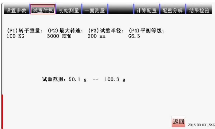
使用【F1-F4】键进入对应菜单项的编辑，编辑后按【开始】键确认。
