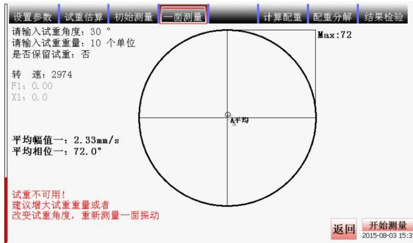
进入一面测量，在开始测量之前，需要在设备上加装试重质量块，然后将试重块所安装的角度、重量、一会是否保留在设备上等参数输入到仪器内。
