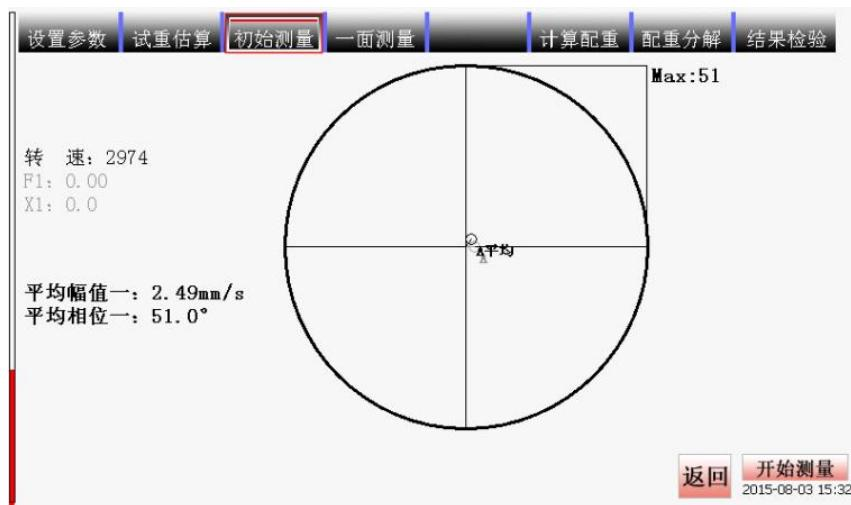
连接好振动传感器和光电转速传感器之后，设备开始运转，转速稳定后按【开始】键开始测量。如果开始测量的时候还在起机状态，如果等转速稳定后幅值相位仍然不稳定，可以停止测量再重新点开始测量。
