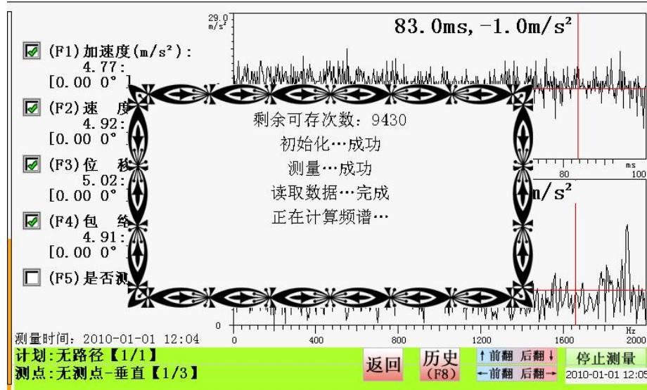
【F0】键切换当前左右键的功能是翻测点还是翻频率线，计划测点区背景为绿色的时候左右键为翻测点，按下 F0，测点区背景变成白色，此时左右键为左右移动频率光标线。
