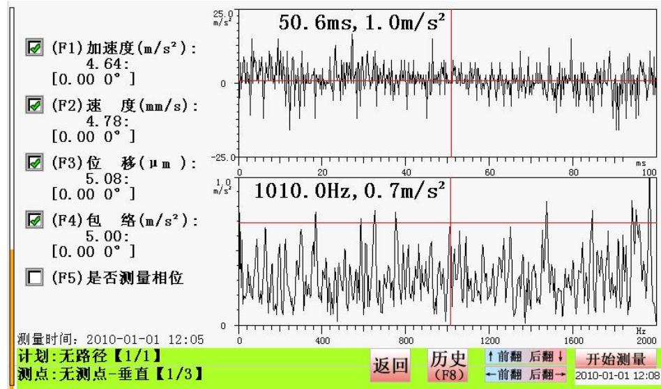
点击开始进行测量，测量完成后右侧可以显示该测点的波形及频谱
