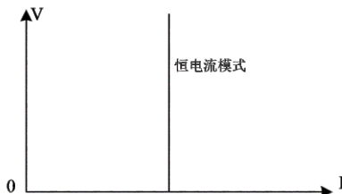
图 5-1 CC 模式电压电流关系图
