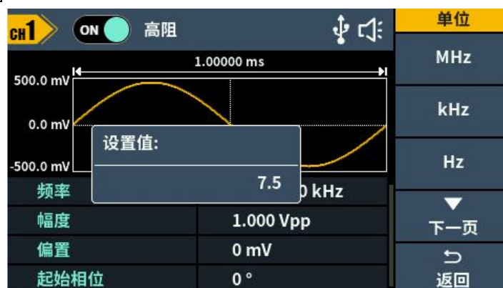
图 5-3：使用数字键盘设置频率
