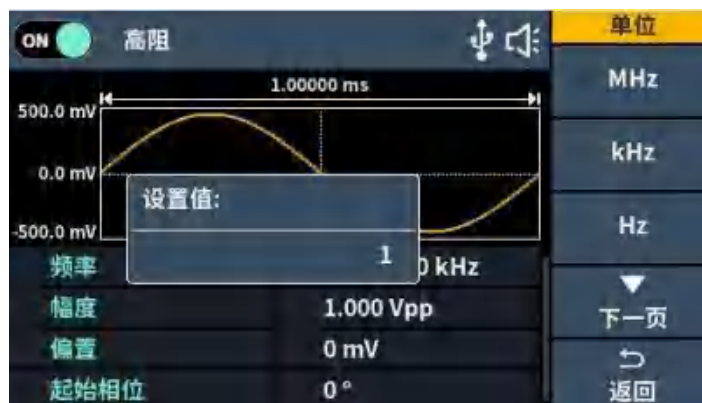
图 5-2：使用数字键盘设置频率
