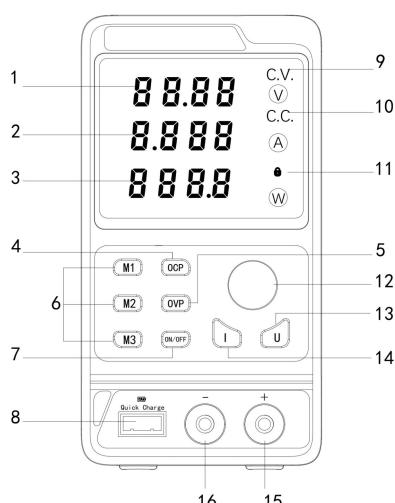
1. **电压值显示窗:** 在待机状态下，显示电压预设值；在输出打开状态下，显示实际输出电压值。单位：伏特（V）。
